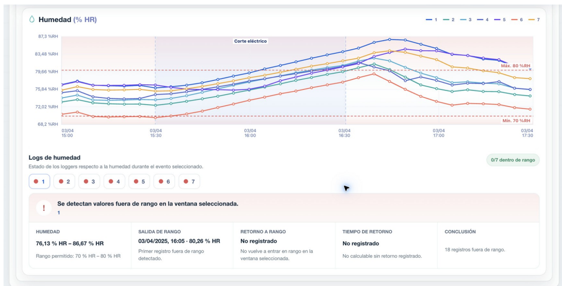
Figura 053. Humedad del evento Corte eléctrico y evaluación fuera de rango.
