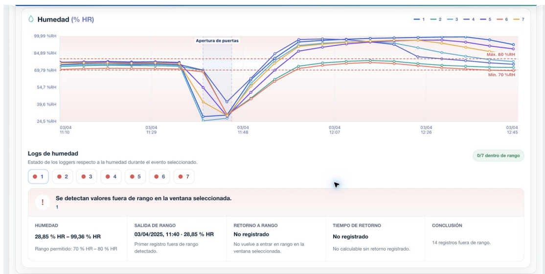
Figura 051. Humedad del evento Apertura de puertas y análisis fuera de rango.
